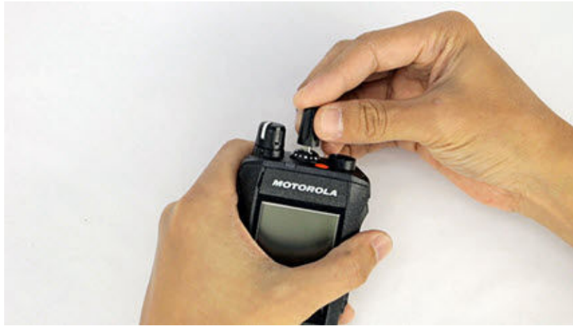
8 لتركيب الهوائي، قم بتدويره باتجاه عقارب الساعة.
