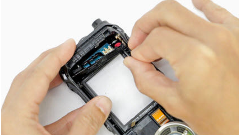
6 أزل لوحة الهوائي باستخدام ملقط.
