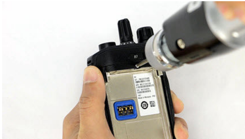
10 اربط الغطاء باستخدام مفك IP Torx 6.
