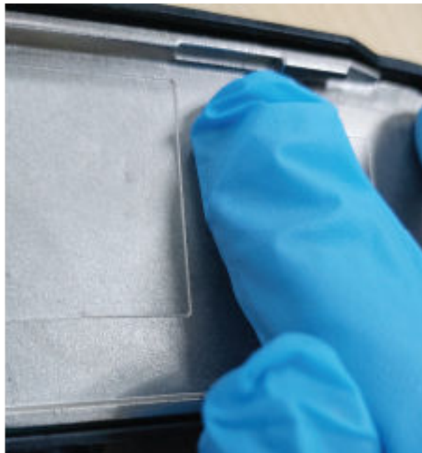
Figura 16: Instalación de la etiqueta de ventilación
