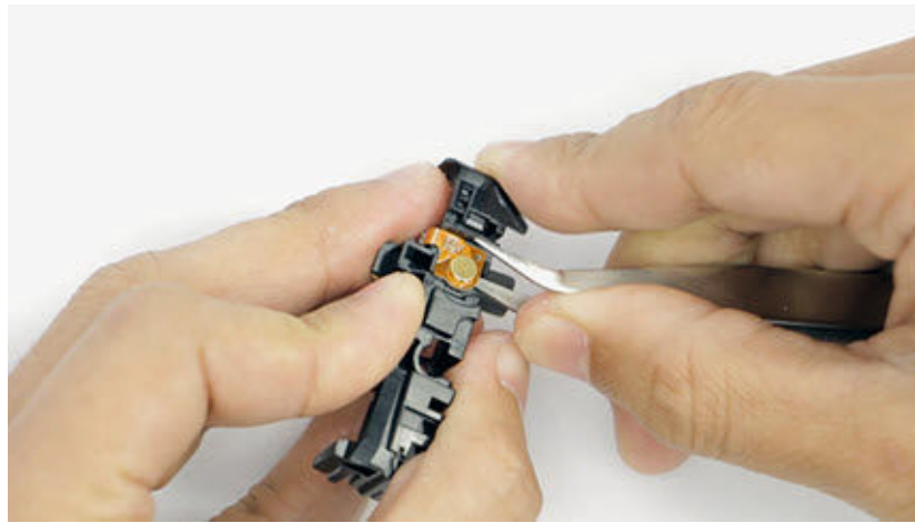
9 أزل وصلة وحدة التحكم العلوية من حامل وحدة التحكم العلوية.
