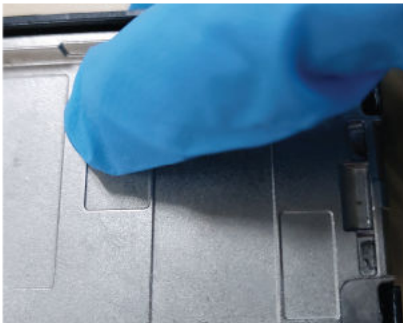
Figura 14: Instalación de la membrana Gore
