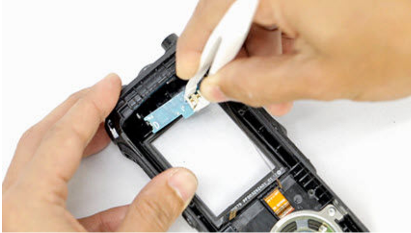
6 أزل لوحة الهوائي باستخدام ملقط.
