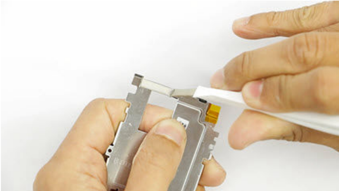
3 انزع نهاية الوصلة الأرضية المثبتة بشاشة LCD.
