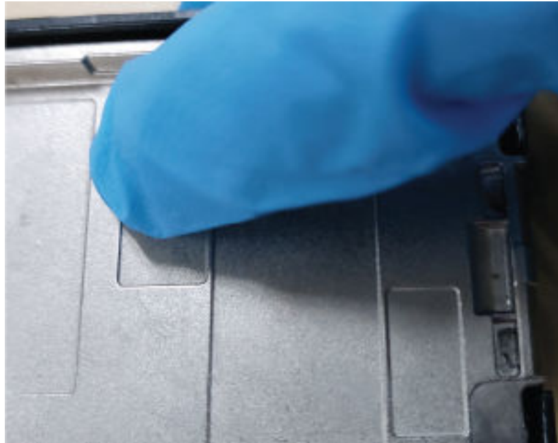
Figura 14: Instalación de la membrana Gore
