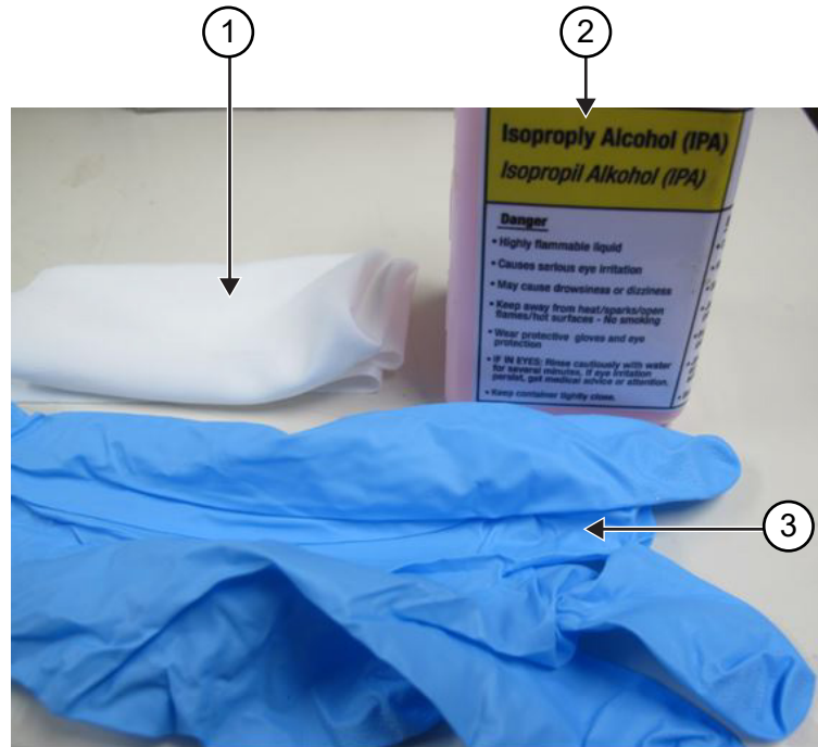
Mesa 51: Elementos necesarios para limpiar la hendidura del chasis
