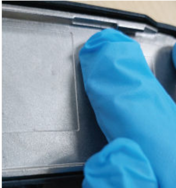
Figure 16 : Installation de l'étiquette de ventilation
