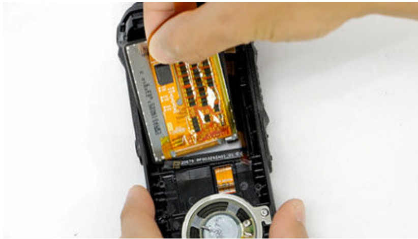
5 أزل أداة احتجاز الهوائي من الغلاف الأمامي من خلال فك الميكروفون الأمامي من أداة احتجاز الهوائي وتثبيت وصلة PTT في الجانب.
