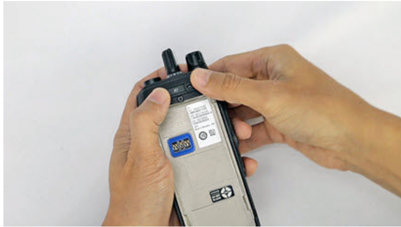
10 اربط الغطاء باستخدام مفك IP Torx 6.
