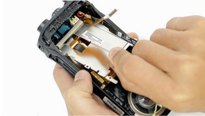
2 قم بإزالة الوسادة الموصلة من أداة احتجاز شاشة LCD.
