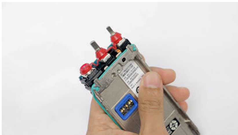
14 اربط لوحة الخيارات العامة بالهيكل وقم بتوصيل وصلتها باللوحة الرئيسية.
